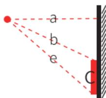
Drücken Sie den Bedienknopf um das Maß "a" zu erhalten, drücken Sie noch einmal um das Maß "b" zu erhalten und drücken Sie noch einmal um das Maß "e" zu erhalten. Das System berechnet automatisch das Maß "c".
