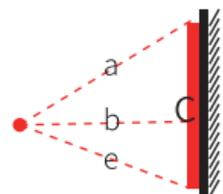
Drücken Sie den Bedienknopf um das Maß "a" zu erhalten, drücken Sie noch einmal um das Maß "a" zu erhalten und drücken Sie noch einmal um das Maß "e" zu erhalten. Das System berechnet automatisch das Maß "c".
