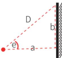
Drücken Sie den Bedienknopf um die Längendaten zu erhalten. Das System berechnet die kürzeste Distanz "a", die Höhe "b" und den Winkel "e".
