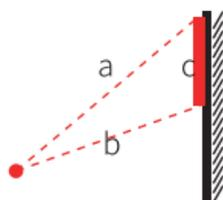
Drücken Sie den Bedienknopf um das Maß "a" zu erhalten, drücken Sie noch einmal um das Maß "b" zu erhalten. Das System berechnet automatisch das Maß "c".
